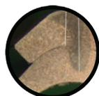
La **soudure laser** offre une excellente pénétration, permet une ultra haute précision et ne nécessite aucun métal d'apport.
